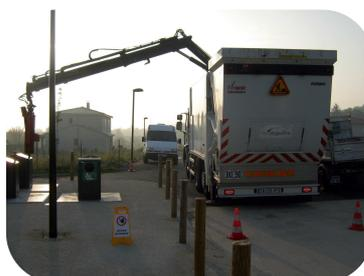
*benne de collecte dédiée aux colonnes enterrées*
